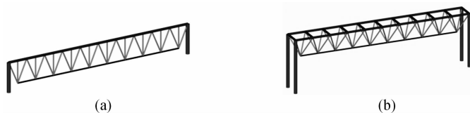
图 11 平面桁架与空间桁架的对比
