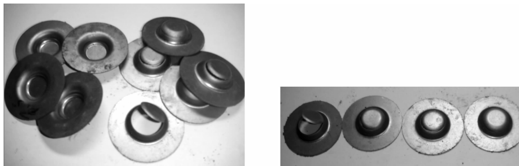
图 9 拉深后工件
