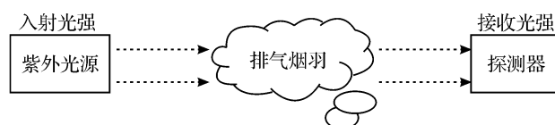
图 1 基于 DOAS 的机动车尾气排气烟羽测量示意
