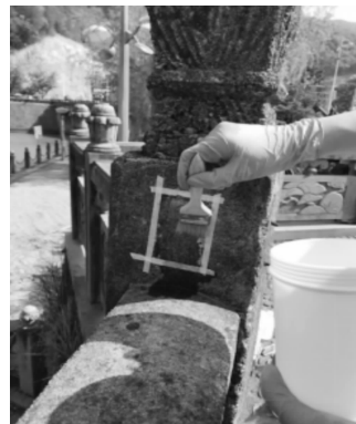
图 5 表面加固材料试验过程 Fig. 5 Test process of surface reinforcement material
