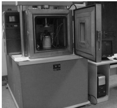
图 1 单轴蠕变强度试验系统
