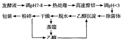
图2 小核菌葡聚糖(Scleroglucan)的回收工艺流程
