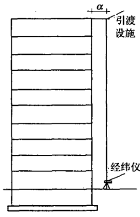
图3 经纬仪天顶测量法示意图
