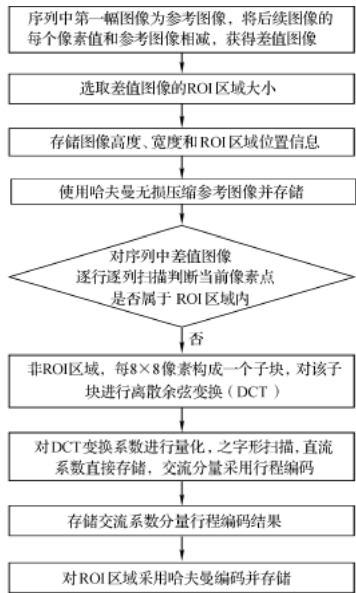
图 3 CT 图像混合压缩算法流程
