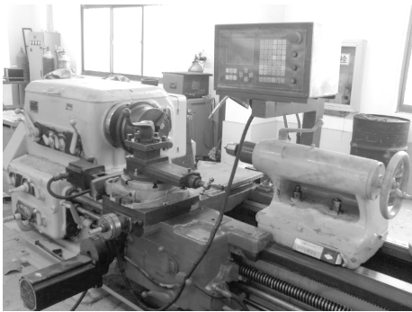
图 3 改造后的数控旋压机
