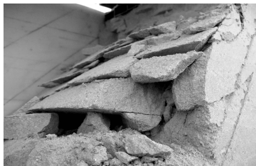
图8 最大荷载下斜坡破坏
