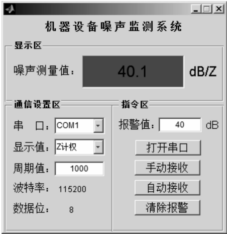
图 4 高于设定值的测量结果 Fig.4 Measurement result above set value
