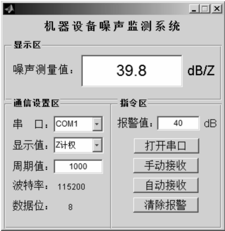
图 3 低于设定值的测量结果 Fig.3 Measurement result below set value
