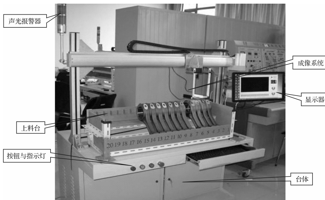
图 10 连杆机器视觉检测系统实物图
