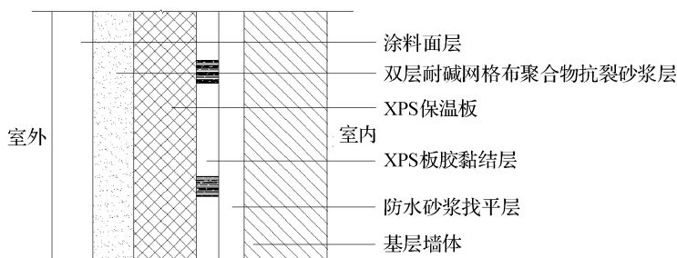
图 1 外墙基层增加防水砂浆找平层施工工艺图
