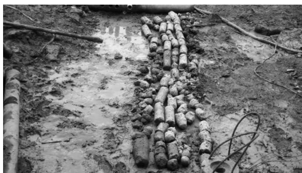
图3 钻孔取芯芯样图
