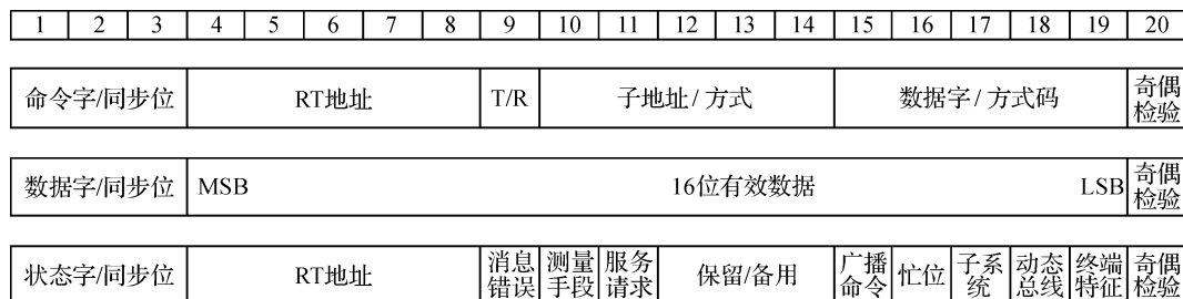
图 5 1553B 总线数据帧格式
