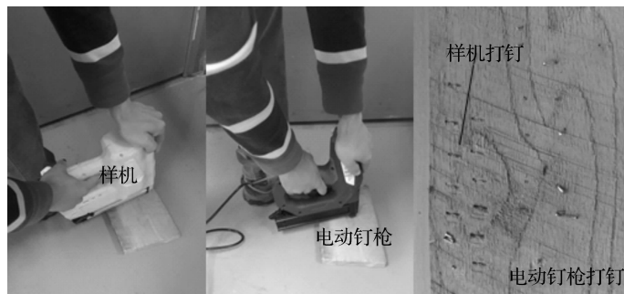
图10 打钉比较试验
