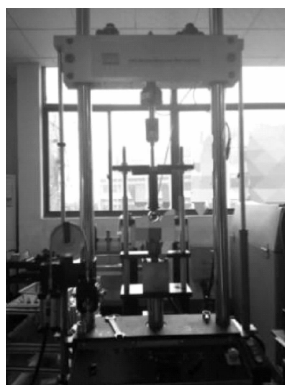
图 3 减振器试验过程
