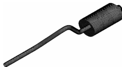
图 2 排气系统有限元模型
